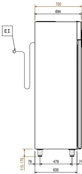
EI = Conexión eléctrica (energía)
